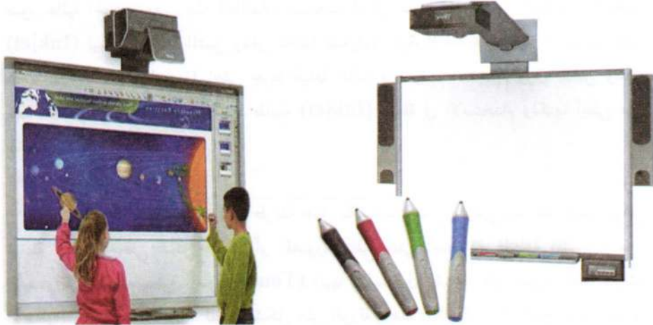
الشكل (2-20) عارض الفيديو واللوحة الذكية التي تعمل باستخدام الأقلام أو باللمس
